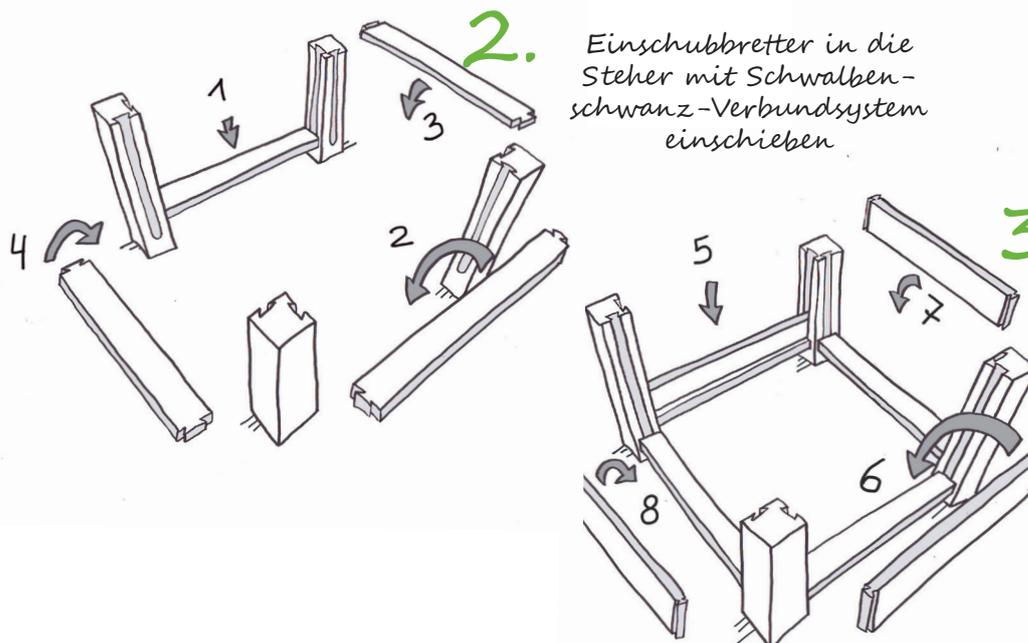
2. Einschubbretter in die Steher mit Schwalbenschwanz-Verbundsystem einschieben
