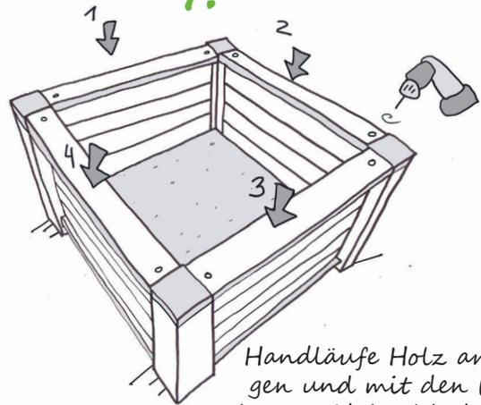
Handläufe Holz anbringen und mit den beigelegten Edelstahlschrauben befestigen
